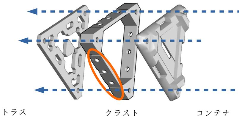
3mm丸棒（プラ棒、プラモのランナーなど）でクラストとコンテナ、トラスを接続します。3mm穴の嵌合は適宜調整してください。個体差もあるので都度様子を見てください。小物入れとして利用する場合、各パーツの接続は接着しないほうがよいでしょう。各パーツの取り外し時に破損させないようにご注意ください。お好みでフィギュアを支えるアーム等と組み合わせてもよいでしょう。
